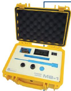
Il modello **MB-1 Mercury Vapor Supply Box** genera vapori di mercurio saturi che possono essere utilizzati per la calibrazione dell'analizzatore.
