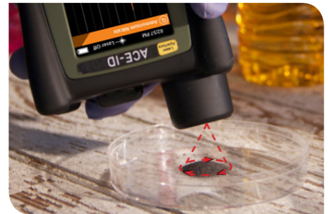
La tecnologia Orbital Raster Scan (ORS) diffonde l'energia laser, riducendo il rischio di riscaldamento dei campioni e di incendio di materiali energetici.
